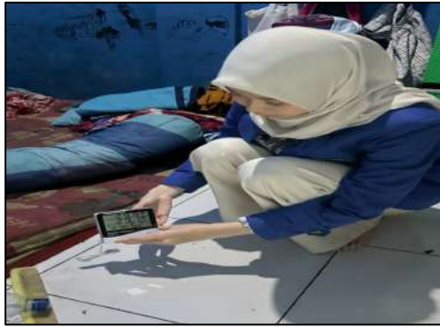
Pengukuran Kelembapan di Kamar Tidur menggunakan alat Hygrometer digital
