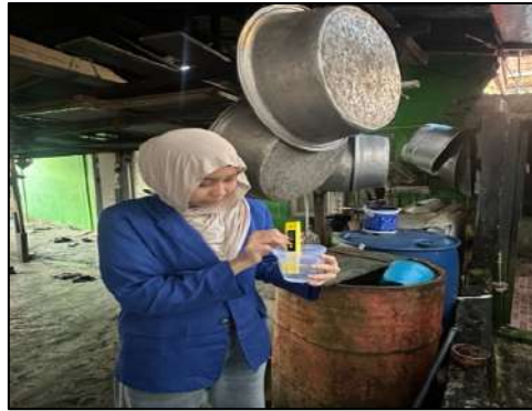
Pengukuran pH air hujan
