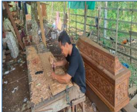
Gambar 2 1 Contoh tindakan tidak mana ( Unsafe action ) pekerja mebel
