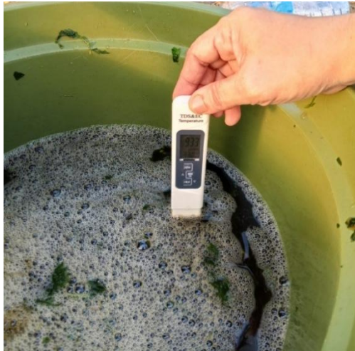
Gambar 7. Ukur Kepekatan Biosaka 330 ppm
